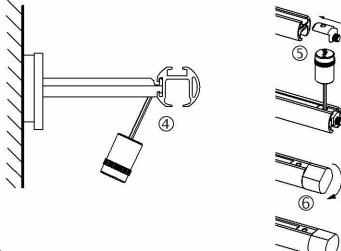
In Verbindung mit Wandlager aus allen Trägern die Schrauben herausdrehen und ins Profil einführen.
